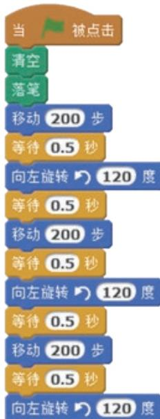
图2-3 顺序结构的程序
