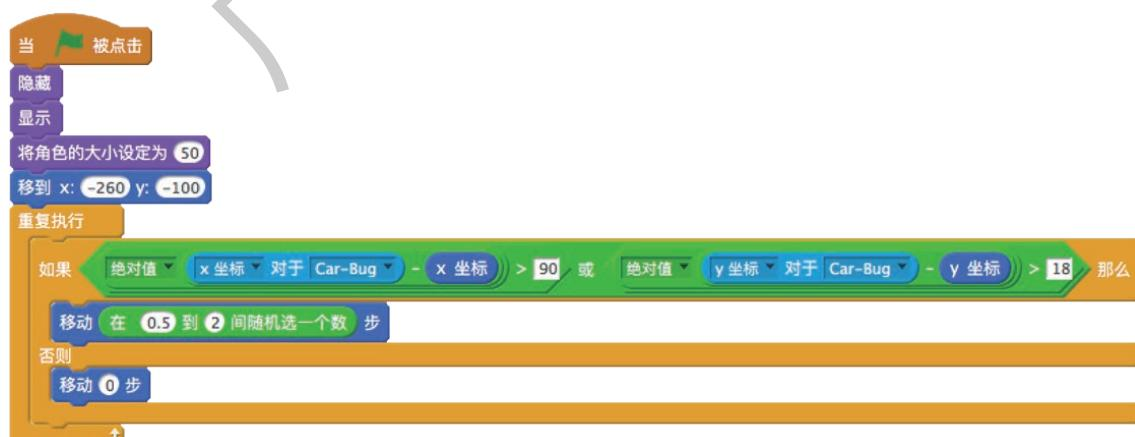
图3-3 无人驾驶汽车角色的程序代码
