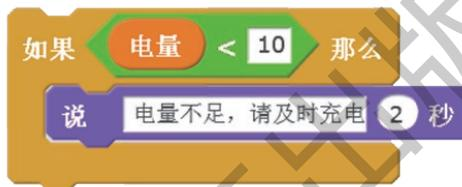
图3-6 电量提示程序代码
